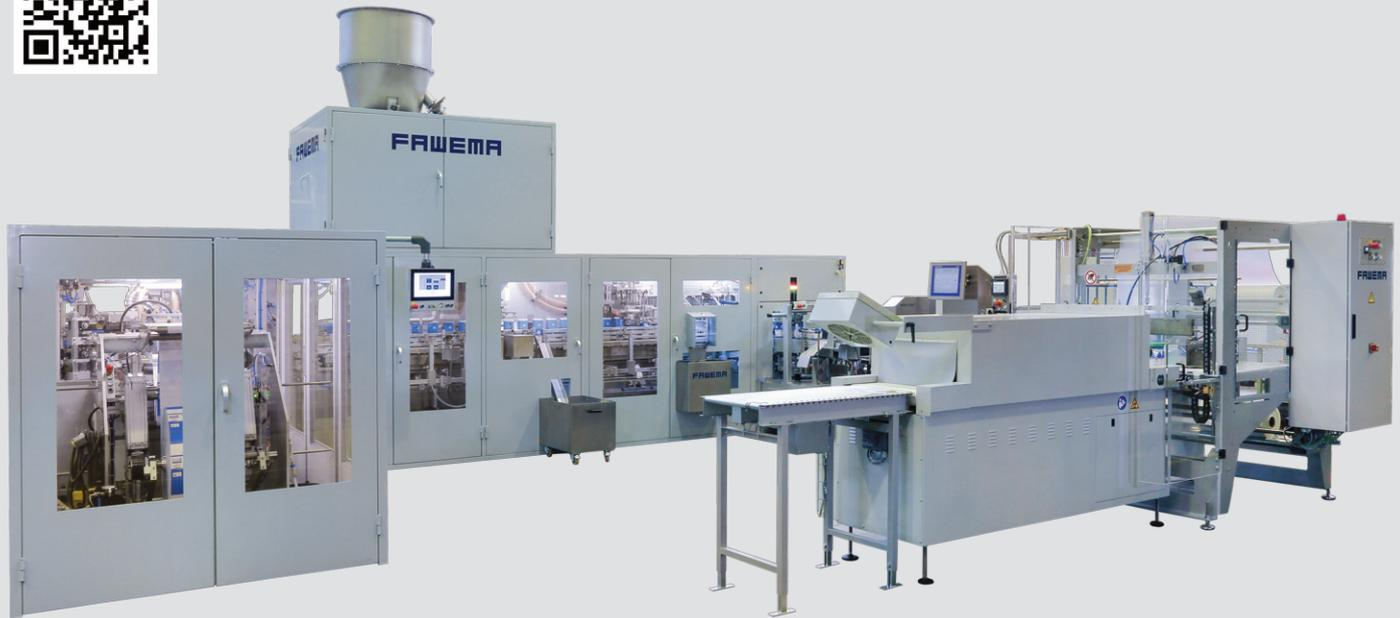
Die in Modulbauweise konzipierte Anlage besteht aus einer sehr soliden und stabilen Schweißkonstruktion. Im Ölbad laufende (geteilte) Zwangskurven, sowie an die Zentralschmierung angeschlossene Hebellagerungen ermöglichen
